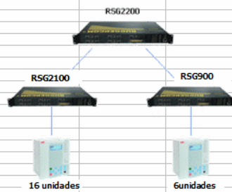
Figura 74 Muestra de resultados en Excel_Esquema de comunicaciones
